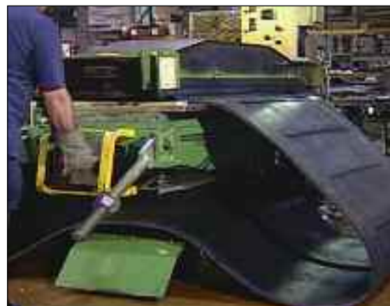
Кроме специальных прессов с нагревательными устройствами для вулканизации требуется персонал, обладающий навыками работы с растворами для вулканизации и другими химическими веществами. Кроме того, это очень трудоемкий процесс.
